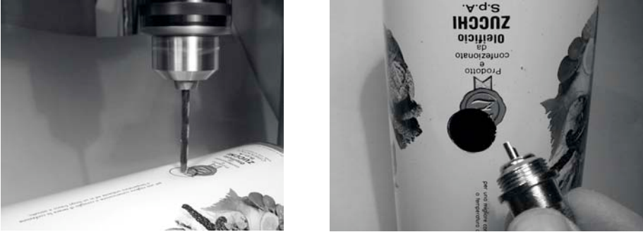
Figure 4.37: Percez soigneusement un trou pilote, puis utilisez une mèche plus grande pour terminer le travail.
