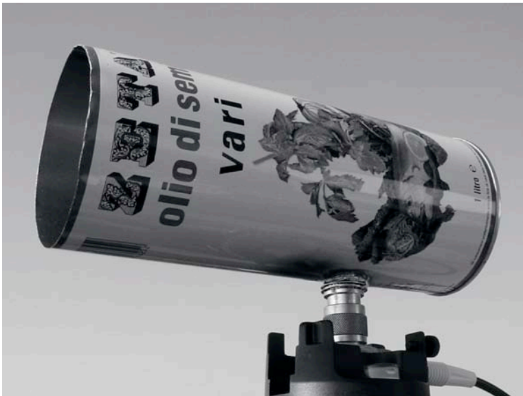
Figure 4.33: Une cantenna finalisée.
