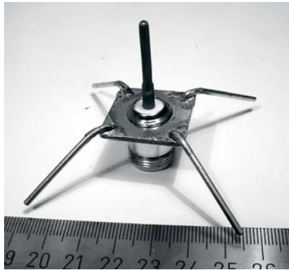
Figure 4.8: Antenne ground-plane d'un quart de longueur d'onde.
