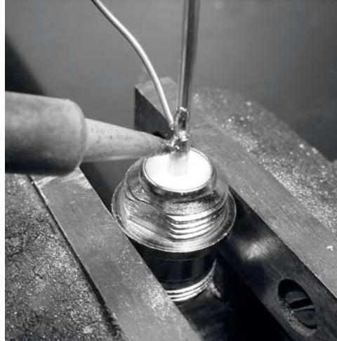
Figure 4.39: Soudez le fil à la pièce dorée du connecteur N.
