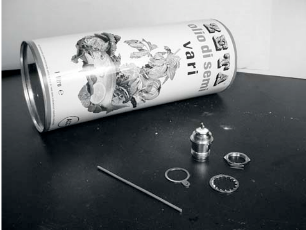
Figure 4.34: Composantes requises pour une cantenna.
