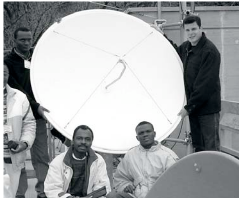
Figure 4.11: Un réflecteur d'antenne parabolique solide.
