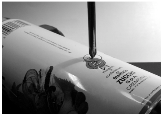
Figure 4.36: Marquez le trou avant de percer.
