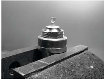
Figura 4.24: Agregar un tubo de cobre espaciador ayuda a obtener la impedancia de la antena de 50 Ohms.
