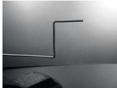
Figura 4.17: Doblar el alambre en forma de "Z".
