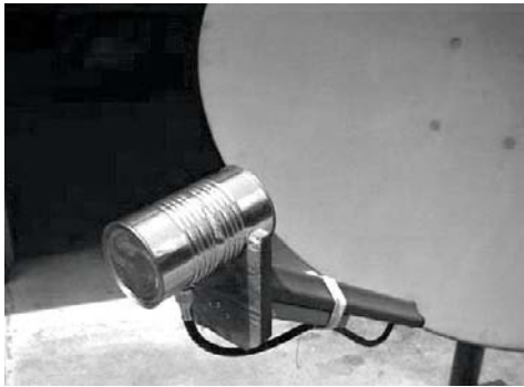
Figura 4.10: Antena bocina hecha con una lata de comida.
