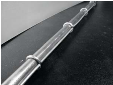
Figura 4.21: Insertar un tubo puede ayudar a enderezar el alambre.
