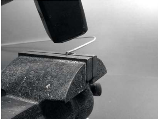
Figura 4.16: Golpee con delicadeza el alambre para hacer una curva cerrada.
