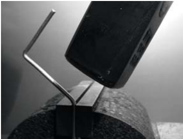
Figura 4.17: Doblar el alambre en forma de "Z".
