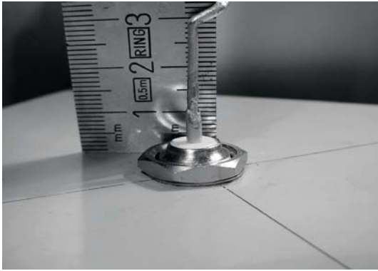
Figura 4.27: El primer anillo debe comenzar a 3,0 cm desde la superficie de la placa
