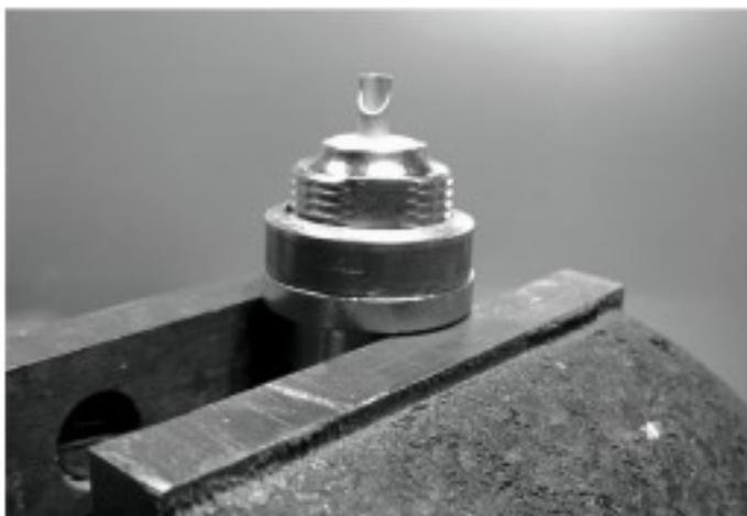
*Figure AC 11: Ajouter un tuyau de cuivre comme entretoise aide à obtenir une impédance d'antenne de 50 Ohms.*
