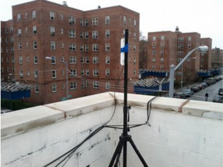
*Figure CsOTI 4 : Premier nœud Wifi de RHI (Ubiquiti Nanostation ) installé sur le toit de l'immeuble qui abrite les bureaux RHI .*
