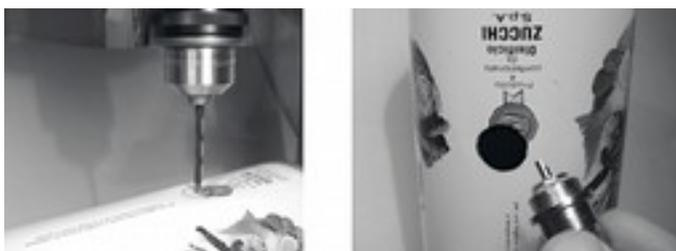
*Figure AC 24: Percez soigneusement un trou pilote, puis utilisez une mèche plus grande pour terminer le travail.*
