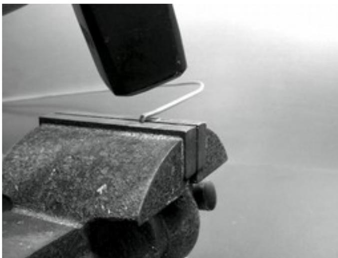
*Figure AC 3: Frapper doucement sur le fil pour faire une courbe fermée.*
