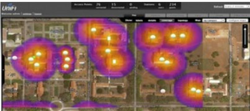
*Figure CSG 7 : Avec UniFi, nous sommes en mesure de simuler la couverture du signal sans fil comme indiqué ci-dessus.*
