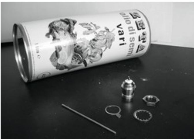
*Figure AC 21: Composantes requises pour une cantenna.*
