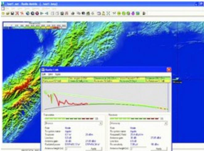
*Figure OI 3: Profil d'une liaison de 280 km sur laquelle les dispositifs WiFi standard avec le firmware OpenWRT permettant l'augmentation des ACKTimeout ont été utilisés pour transférer des fichiers à environ 65 kbps en Avril 2006 entre Pico del Aguila et El Baul au Venezuela.*
