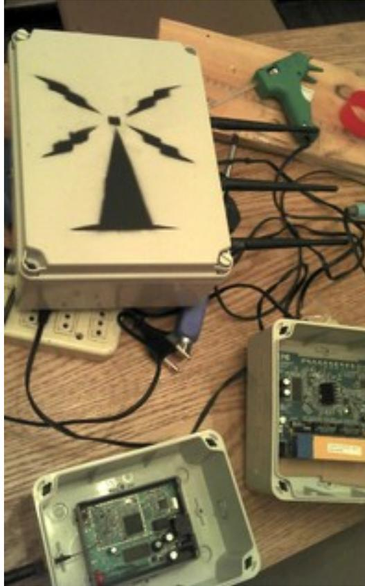
*Figure MN 4: routeurs extérieurs de bricolage basés sur le circuit imprimé provenant de routeurs SOHO (Photo montrant deux dispositifs basés sur le TP-Link WR741 et le WR941 et un basé sur un routeur Fonea )*
