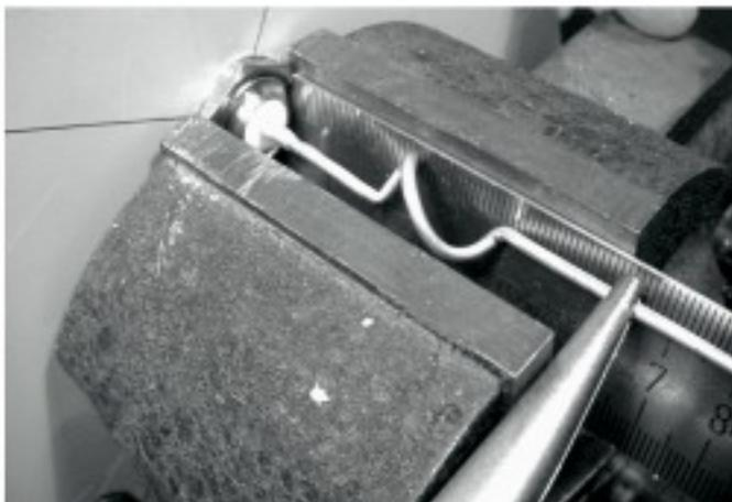
*Figure AC 15: Étirer les boucles. Procédez en douceur et essayer de ne pas érafler la surface du fil avec les pinces.*
