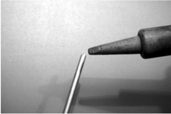
*Figure AC 25: Ajouter de l'étain à l'extrémité du fil avant de souder.*
