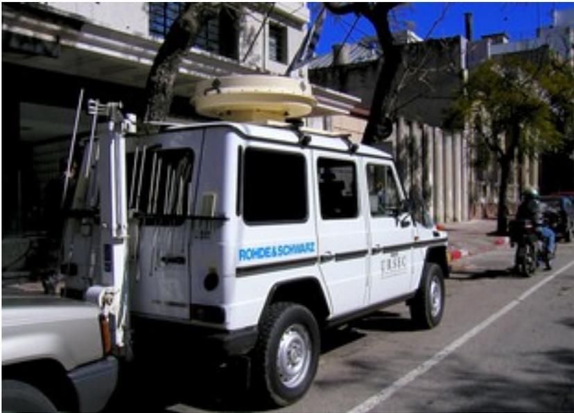
*Figure RS 2: Un véhicule spécial pour la surveillance du spectre dans Montevideo, en Uruguay.*
