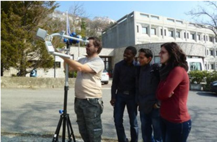
*Figure RS 6 : Les participants en provenance d'Albanie, du Népal, du Malawi et l'Italie testent une antenne avec l'analyseur de spectre RF Explorer à Trieste, en février 2012.*
