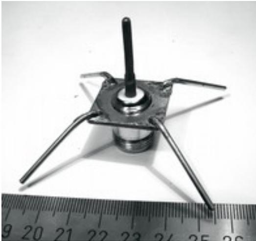
*Figure ATL 11 : Antenne à base plane d'un quart de longueur d'onde.*
