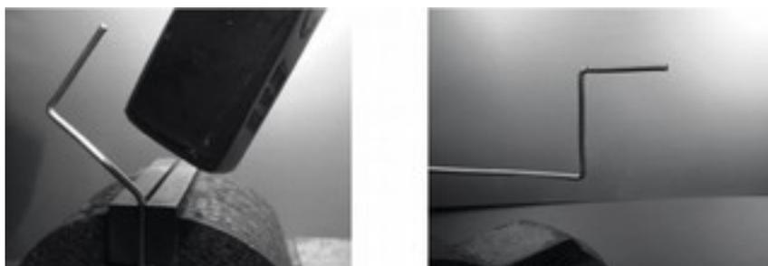
*Figure AC 4: Plier le fil en forme de « Z ».*
