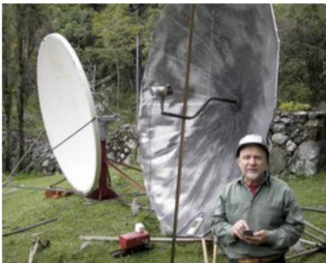
*Figure CsLD 6: Trouver le focus de l'antenne avec une alimentation de 2,4 GHz*
