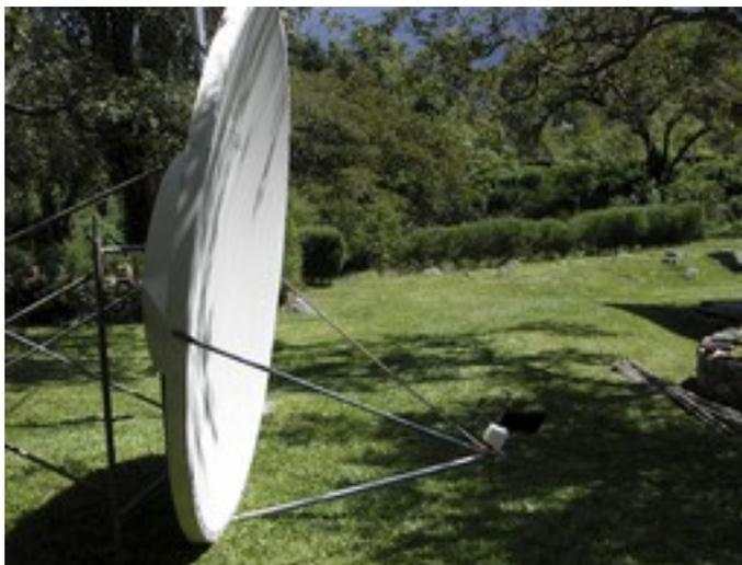
*Figure CsLD 4: Réflecteur d'alimentation offset de 2,4 m avec une antenne de 12 dBi à son foyer, tourné  $14^\circ$  vers le bas. L'élévation réelle est de  $8^\circ$  vers le haut.*
