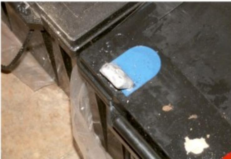
*Figure OGP 2: Une batterie plomb- acide 200 Ah. La borne négative a été cassée à cause d'une pression exercée sur les bornes pendant le transport.*
