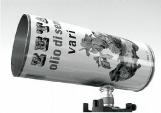
*Figure AC 20 : Une cantenna finalisée.*
