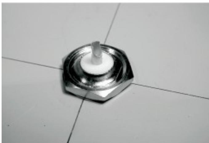
*Figure AC 12: Fixez étroitement le connecteur N à la plaque.*
