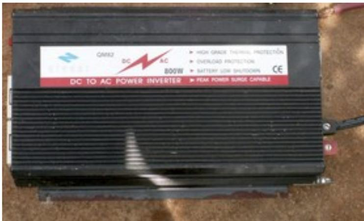
Figure OGP 4: Un convertisseur (onduleur) de 800 Watt DC/AC.
